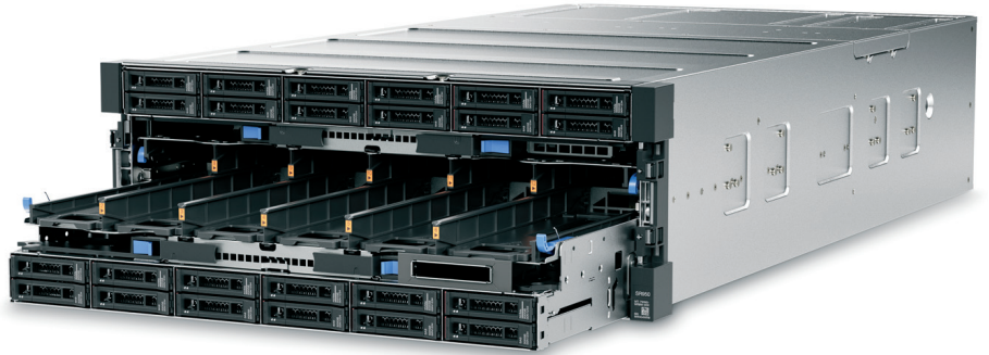
上下计算托架可从机箱前面滑出，便于升级和维护。
